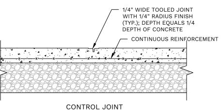
TYPICAL CONCRETE SIDEWALK JOINTS NOT TO SCALE
